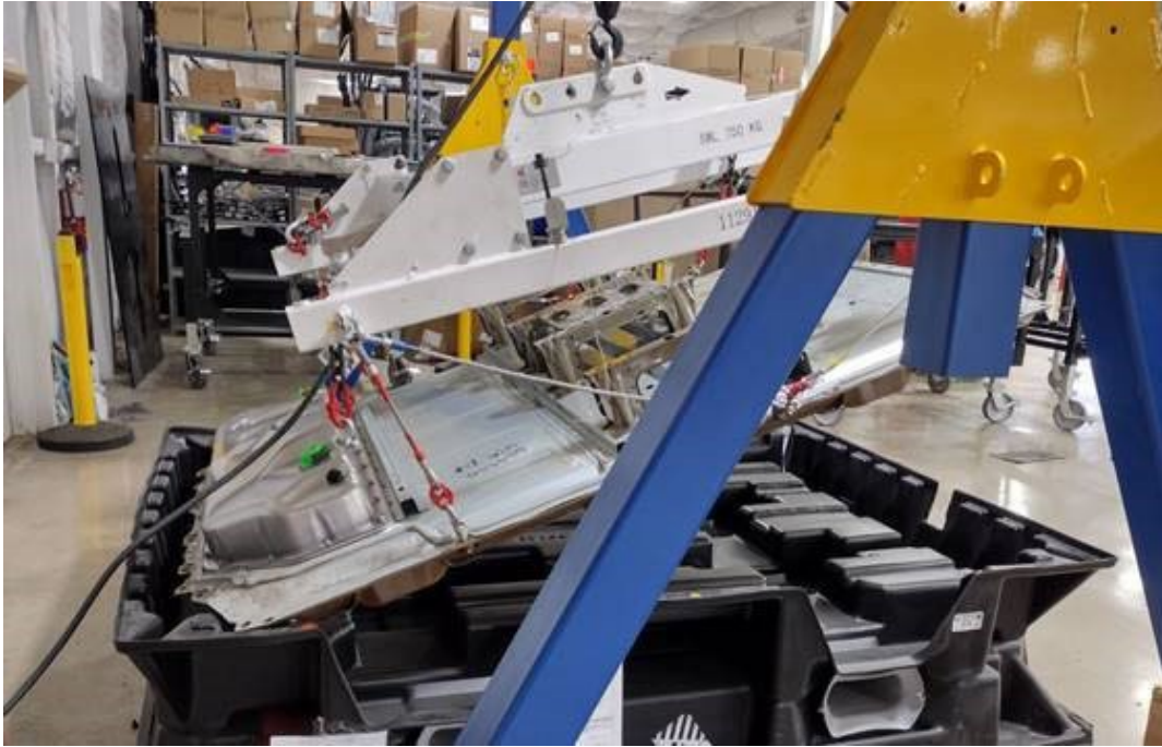
図 2.HVバッテリーに不適切に取り付けられた吊り具は危険です。
