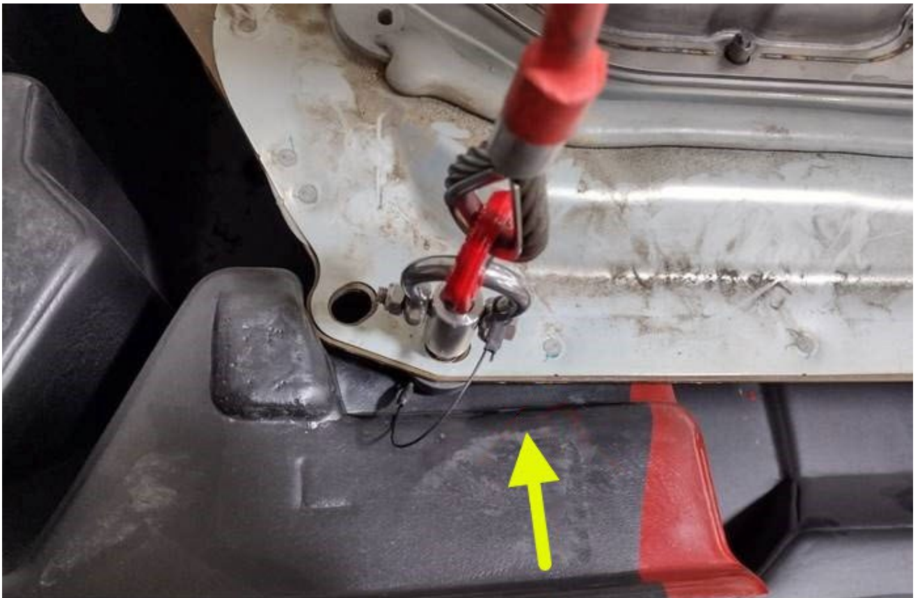
図1.プラスチック・パレットを圧縮して、ロッキング・ジョイントをスペースを作る。
