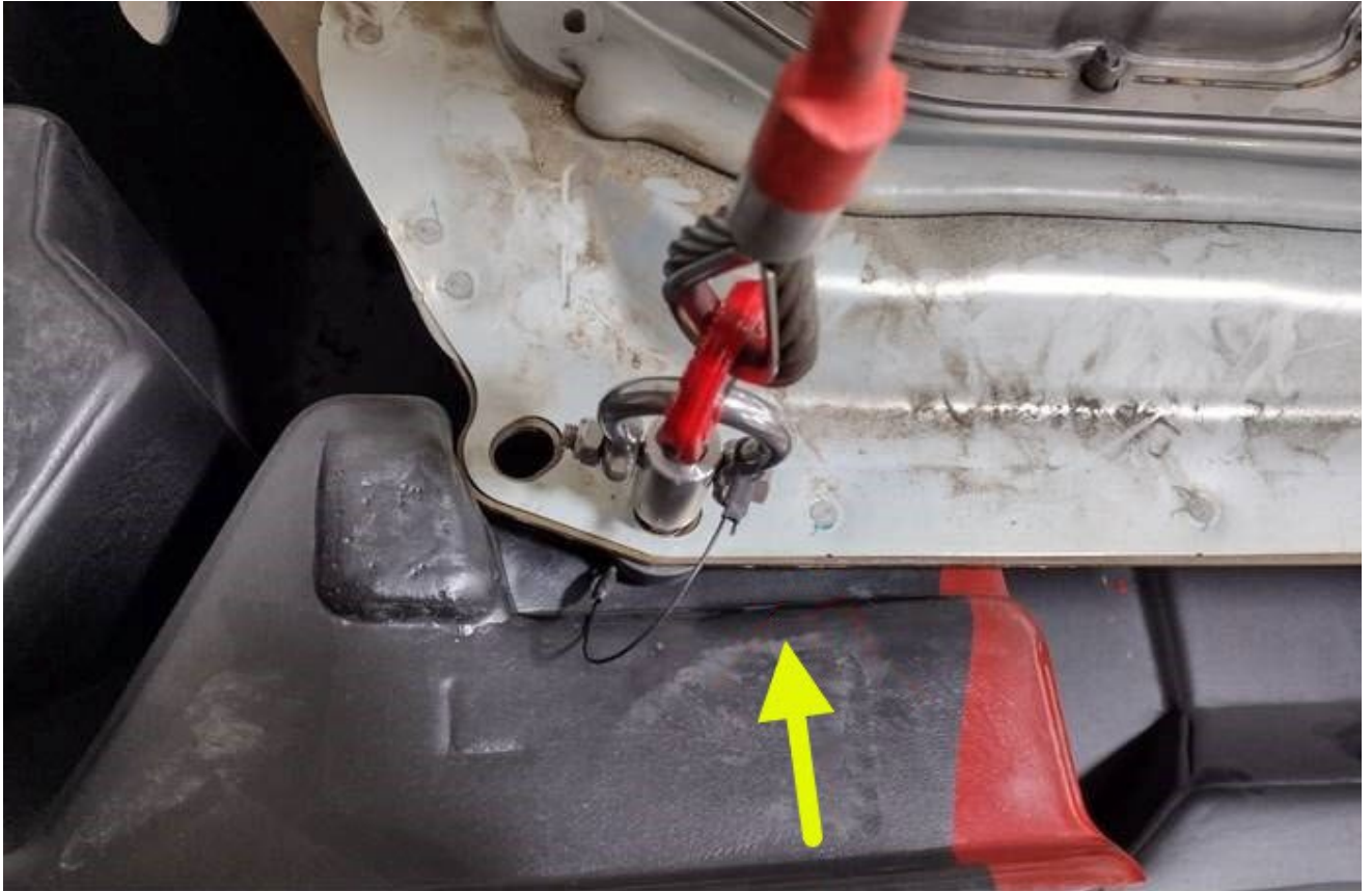
図3.プラスチック・パレットを圧縮し、ロッキング・ジョイントを外すスペースを作る。
