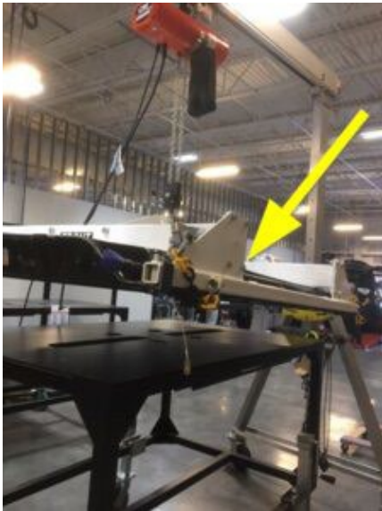
11. 古いHVバッテリーをHVバッテリー箱の高さより上に上げる。
