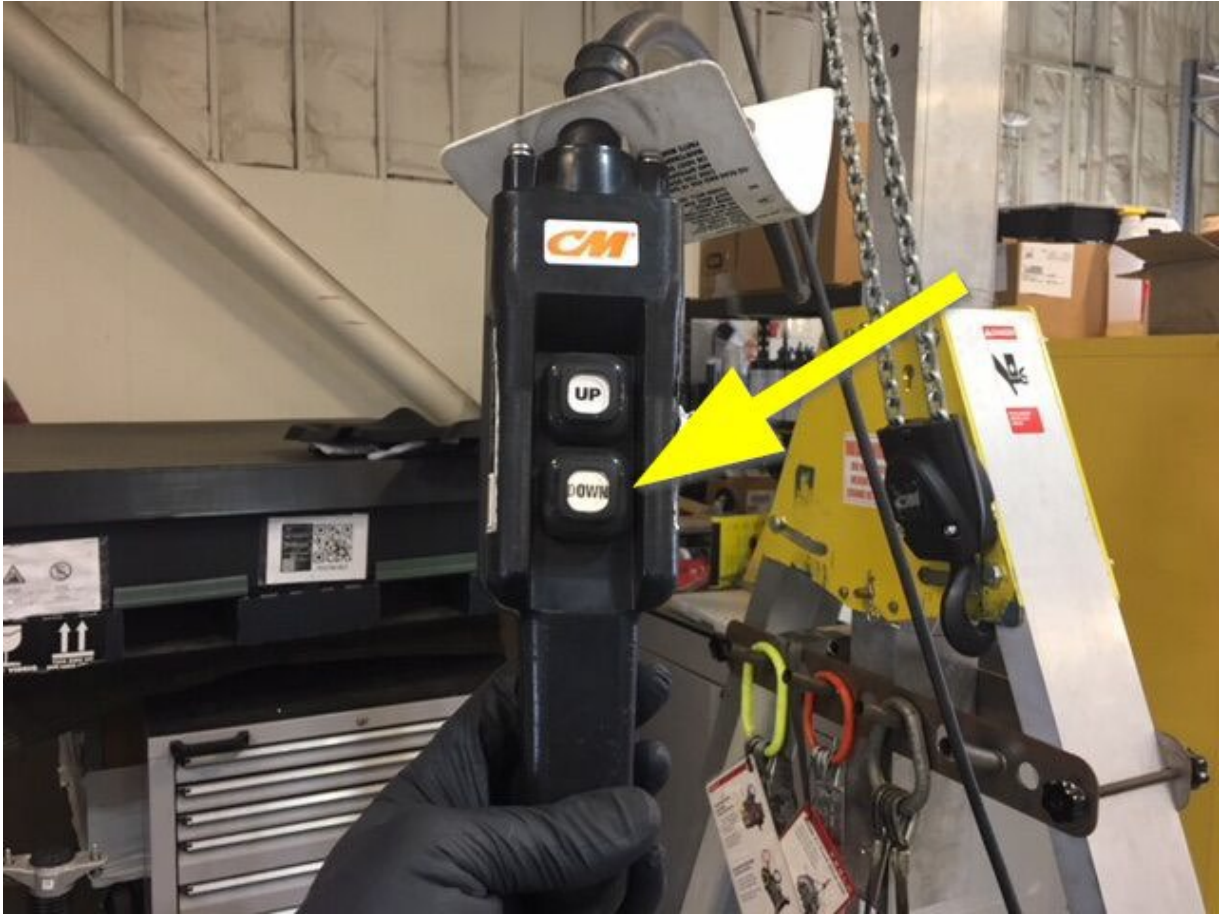
16. ガントリーを下降させ、ガントリーからHVバッテリーのHフレームを取り外す。
