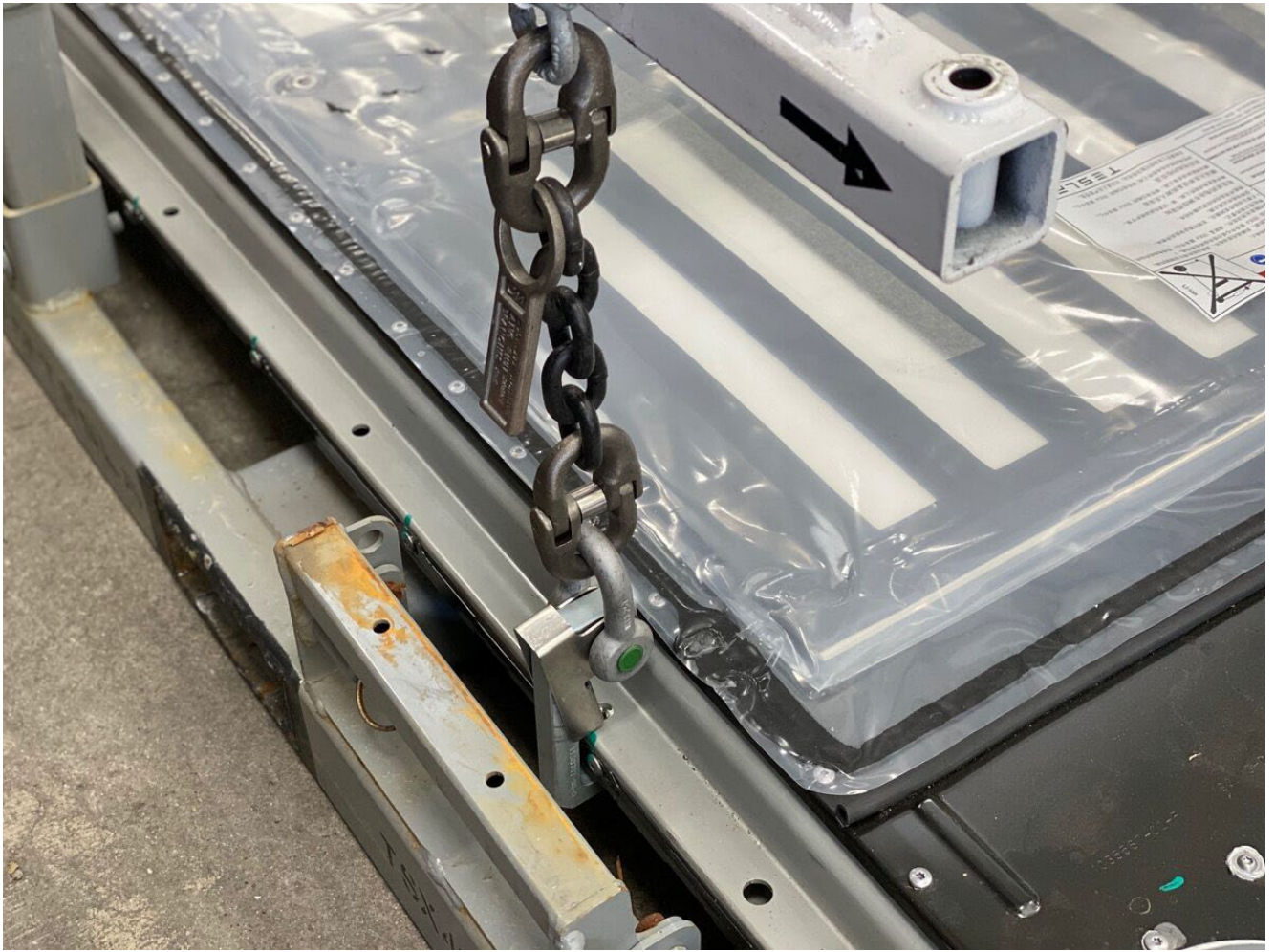
11. 古いHVバッテリーをHVバッテリー箱の高さより上に上げる。
