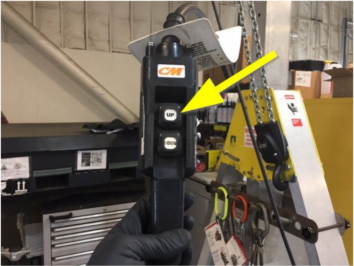
16. ガントリーを下降させ、ガントリーからHVバッテリーのHフレームを取り外す。
