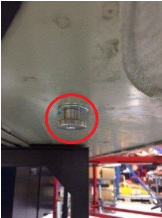
25. HVバッテリーを車両の下に配置する。
