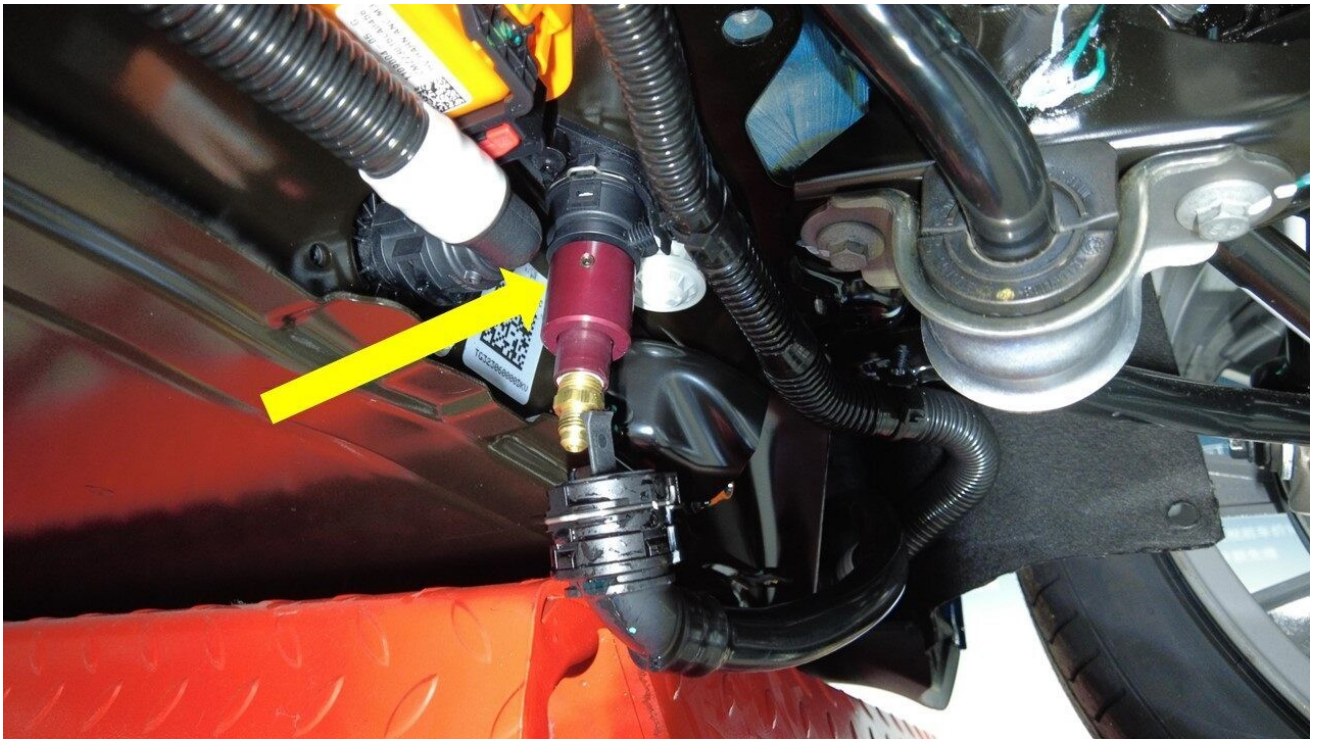
118. クーラント圧力テストを圧力フィッティング・アダプタに取り付けます。
