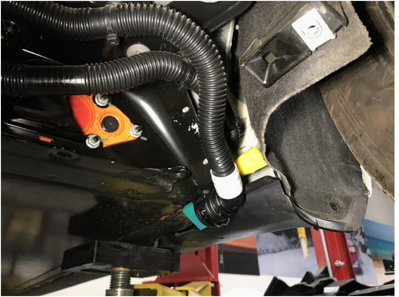
129. リアサブフレームの前部を支える。
