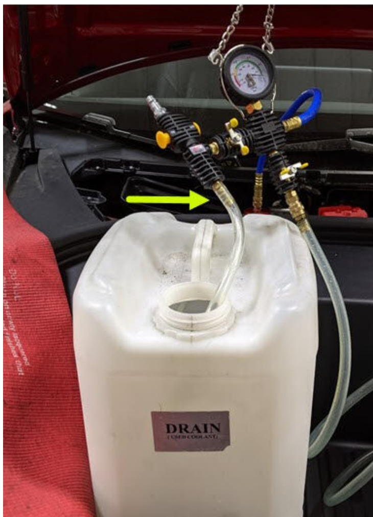
99. 充填したクーラント容器の中に補充ホースを入れます。
