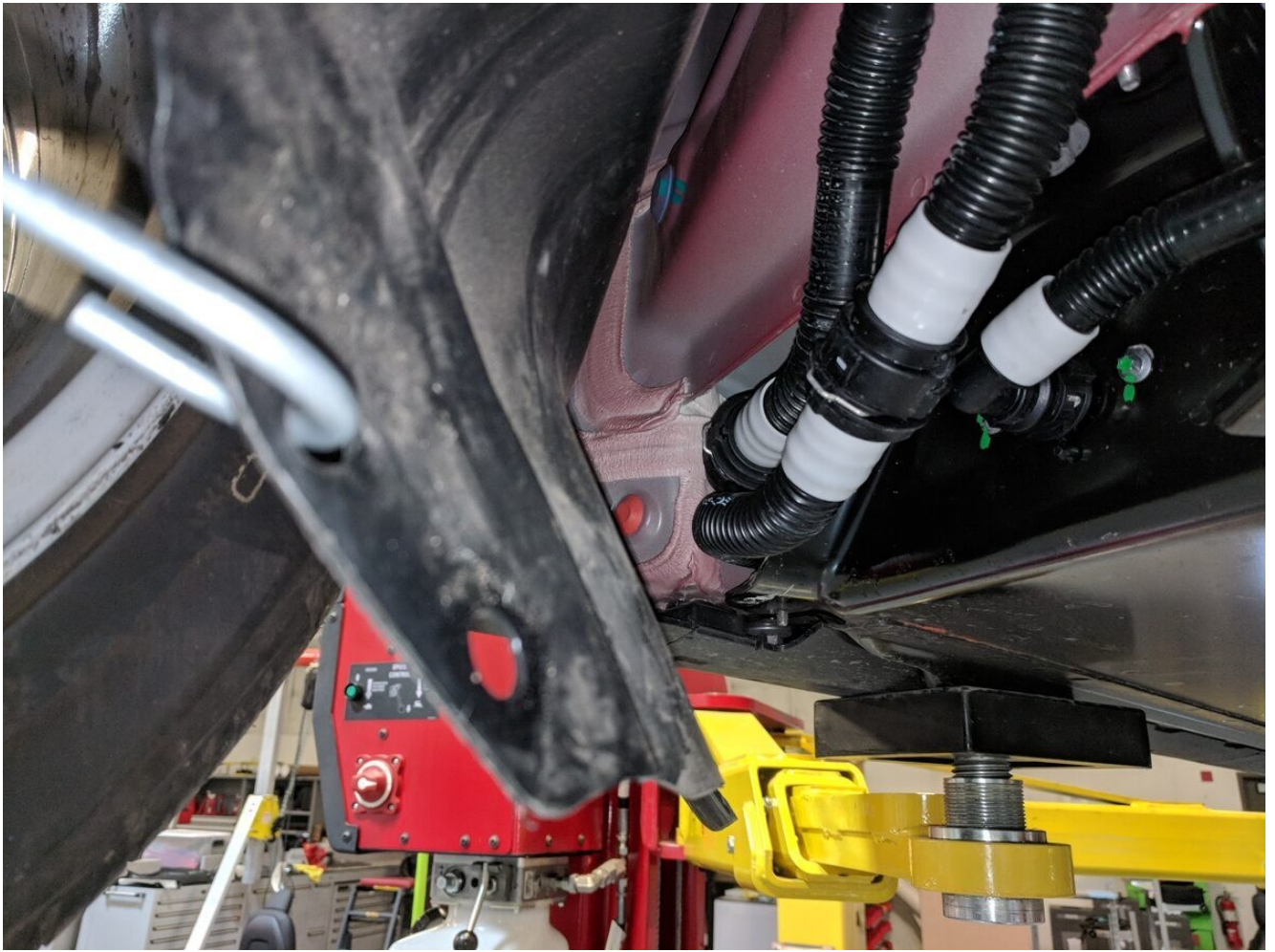
94. クーラントドレン容器をHVバッテリー前面RHの下に置きます。
