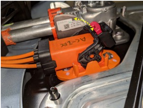
図1.3相HVバッテリーのAC充電インターフェース
