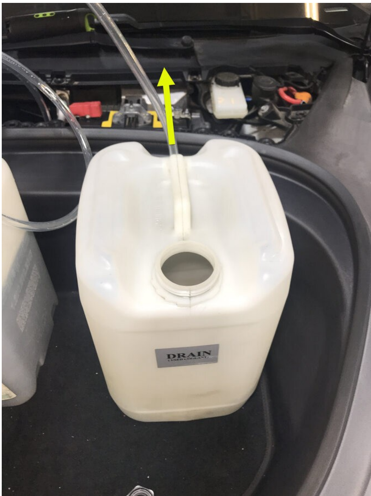
110. クーラントボトルの補充キャップからバキューム補充ホースを取り外します。
