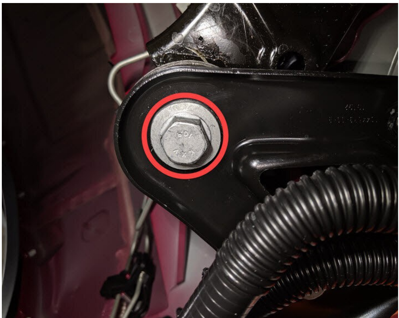
67. LHシャーププレートをHVバッテリーに固定しているボルトを手締めで取り付ける。
