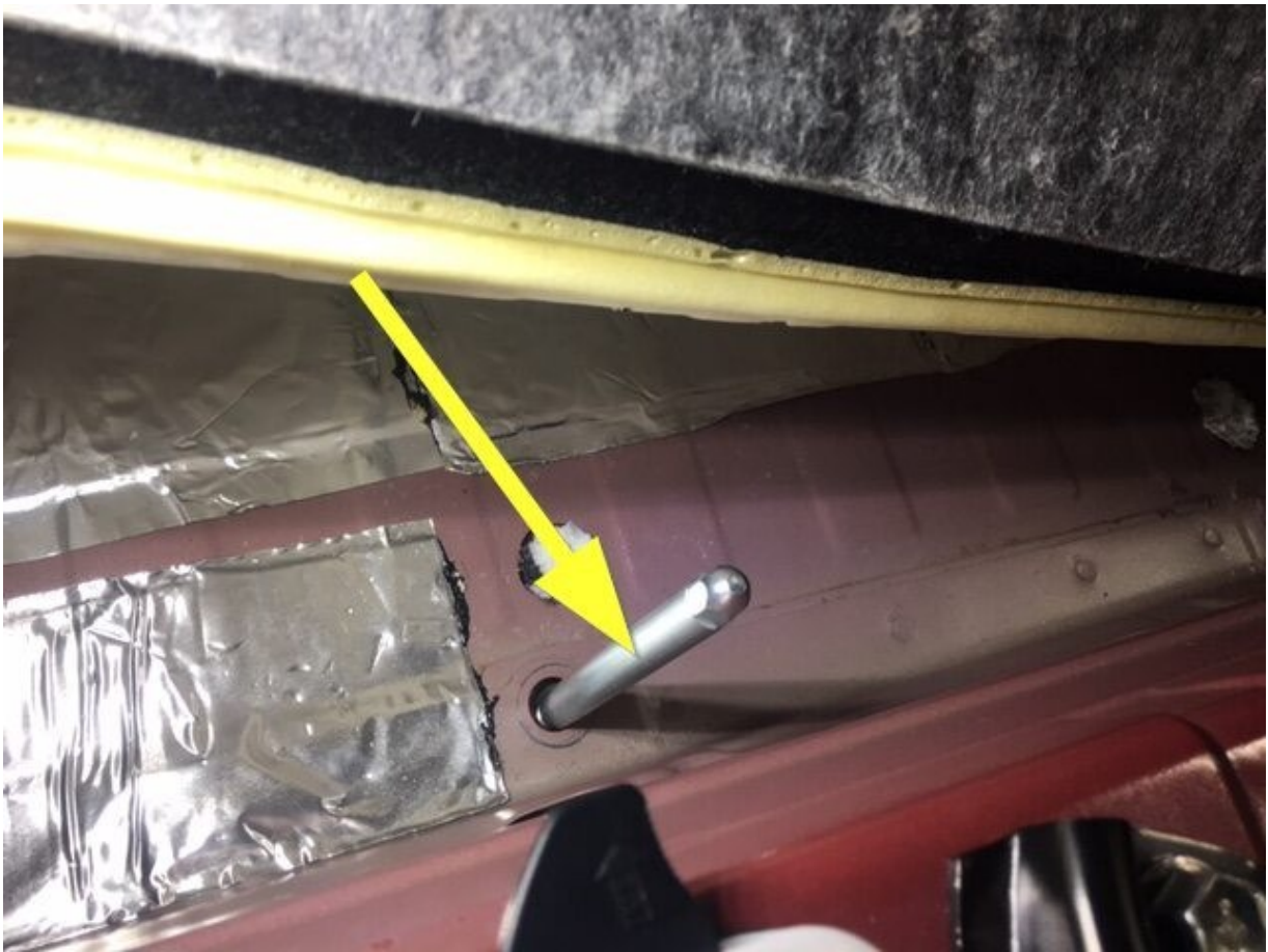
38. RHフロント・サポート・ブラケットを車両に固定しているボルトをコードレス・インパクトでセットする。
