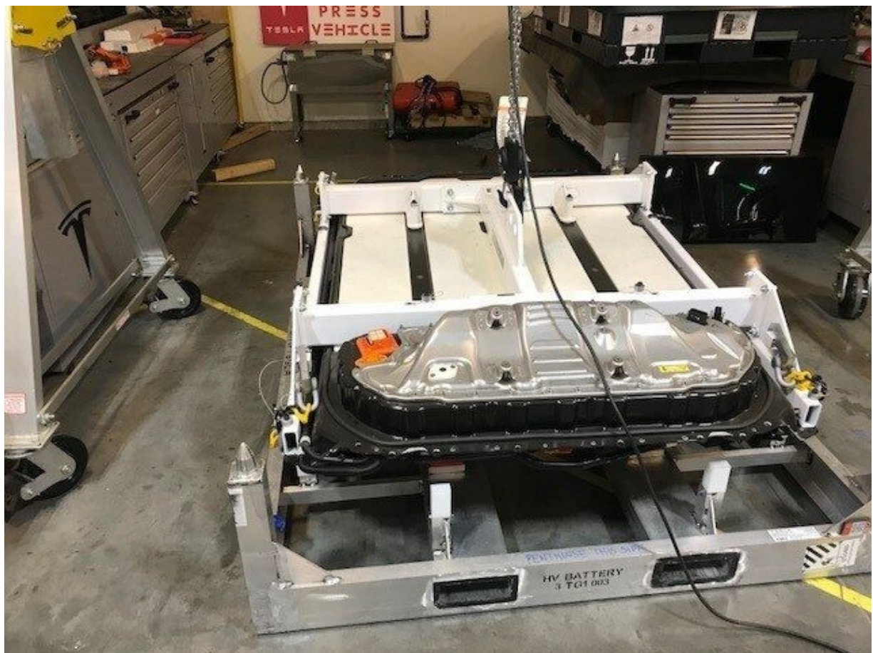
164. HVバッテリーをパレットに下ろす。
