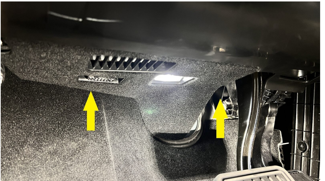
142. LH下部Aピラーアセンブリを取り付けます。
