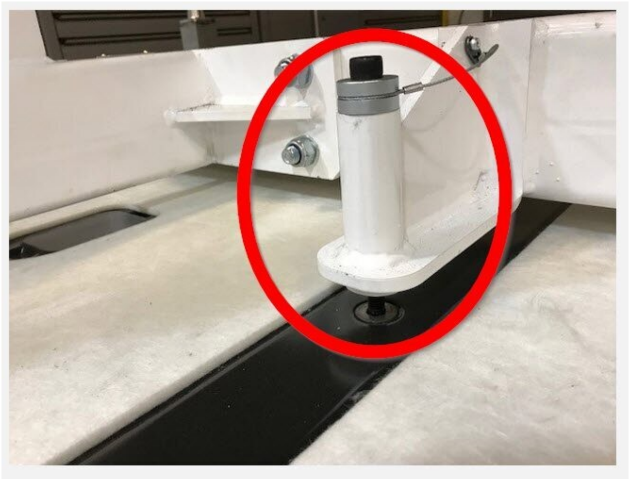
166. 古いHVバッテリーからガントリーとHフレームを引き上げる。
